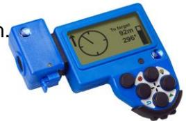
Avec le logiciel **TopiTax** ou **AMTreeTax** et le **DP DME GPS** rend l'aménagement forestier encore plus efficace. L'accessoire **DP DME GPS** sur l'interface RS232 mesure la distance par rapport au cœur de l'arbre en appuyant sur un bouton pour le centre d'échantillonnage (transpondeur) et peut enregistrer en même temps les coordonnées. Demandez une description détaillée du logiciel à l'adresse : [admin@fomea.ch](mailto:admin@fomea.ch)
